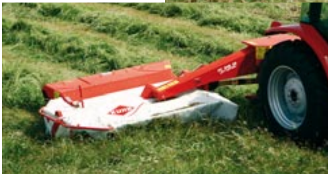
De maaieunit beschikt over een grote verticale pendel mogelijkheid, wat ook bij grote werkbreedtes een perfect maaierwerk levert.
