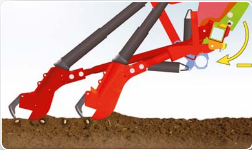
Position de la butée basse pour une profondeur de 1 cm
