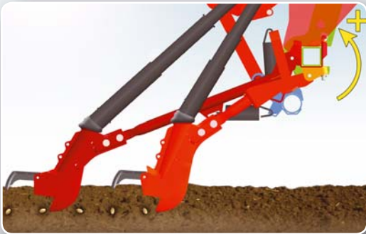
Position de la butée basse pour une profondeur de 8 cm
