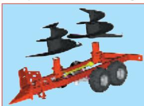
**Châssis indépendant** de série pour une meilleure stabilité de pesée et une meilleure longévité de la machine. Essieu simple pour les versions 1670 et 2070 et essieu bogie pour le modèle 2270.
