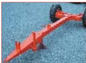
**Châssis indépendant de série.** Il est le gage de la précision de la pesée. Son indépendance par rapport à la caisse permet le chargement et le pesage machine dételée !
