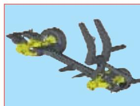
**Suspension intégrale.** Les essieux sont suspendus par ressorts à lame pour le plus grand confort du conducteur. Le châssis monopoutre de forte section compense les contraintes liées au chargement et aux trajets.
